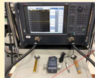
図2. 電波吸収体の透磁率と誘電率を測定するベクトルネットワークアナライザ。
